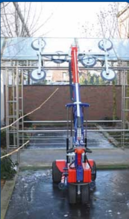
Dlouhý teleskop umožňuje instalace ve výšce 3 m
