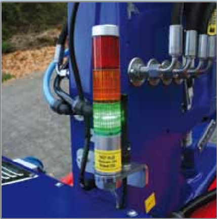
Drobné detaily pro větší bezpečnost, hlášení při ztrátě vakua.
