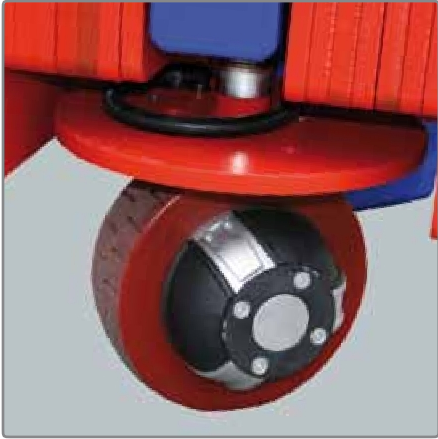
Otočná zadní pneumatika umožňuje malý poloměr otáčení 360°.
