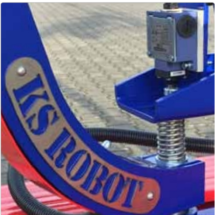
Bezpečnostní zařízení s vypínacím modulem v případě přetížení ve standardní výbavě.
