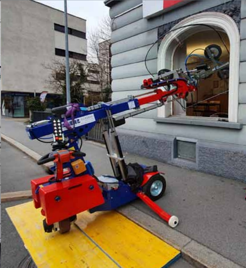
Teleskopický výsuv, zvedání a spouštění se provádí elektricky pomocí vysoce kvalitního synchronizovaného ovládání.
