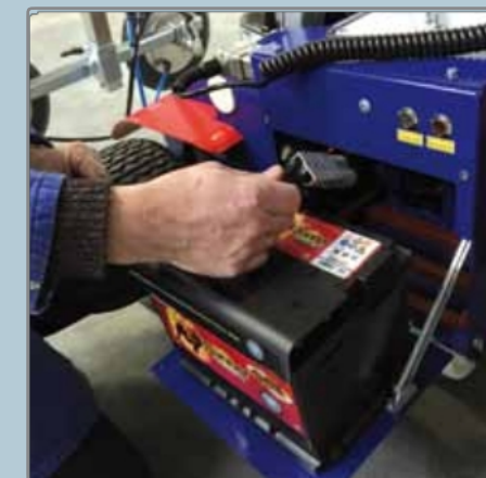
Vyměnitelné vysoce výkonné baterie
