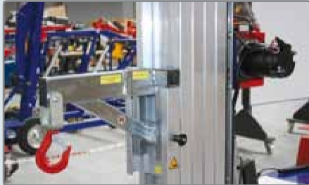
Můžete mít zařízení s nákladním hákem nebo s nákladní vidlicí.
