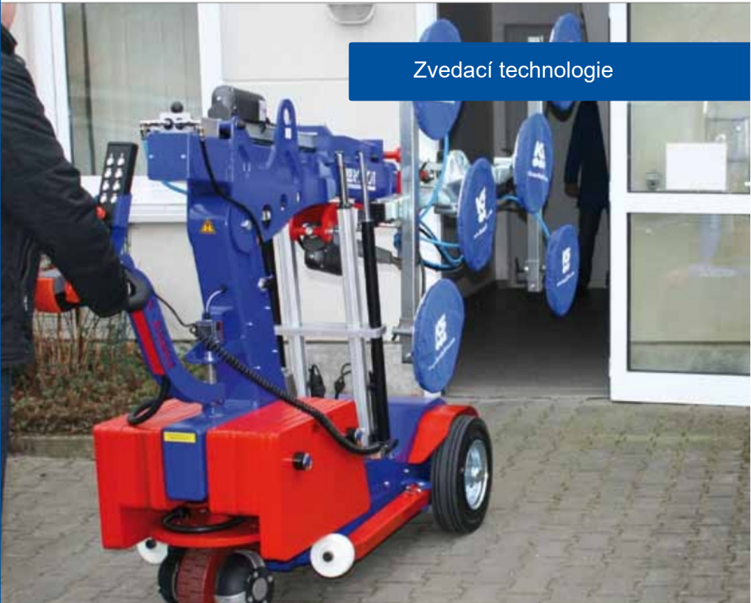
Díky otočnému kloubu se sací zařízení otáčí v úhlu 90° do strany pro průjezd malými otvory.
