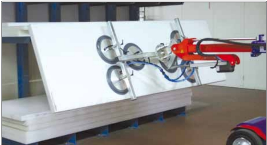
KS Robot dokáže vzít z regálu těžké plastové desky o hmotnosti 600 kg, položit je na paletu a přehoupnout je přes hlavu*.
