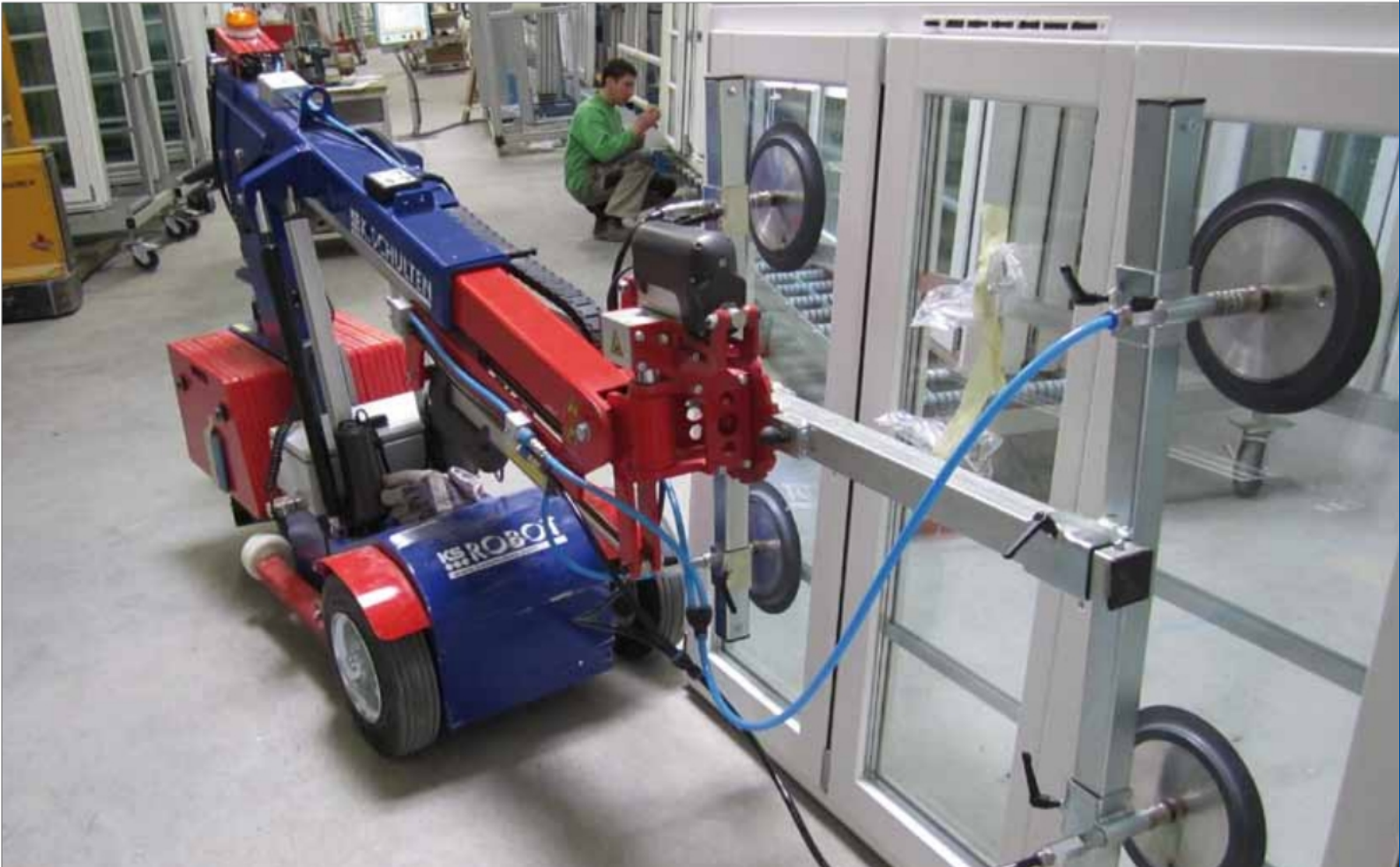
KS Robot 400 s elektrickým bočním otáčením* sacího systému.
