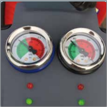
Displej zobrazuje výkon sací jednotky a varuje vás v případě ztráty podtlaku
