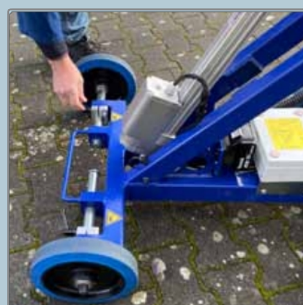
Nastavitelná šířka pro větší stabilitu
