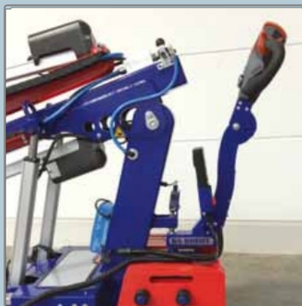
Skládací tyč řízení šetří místo
