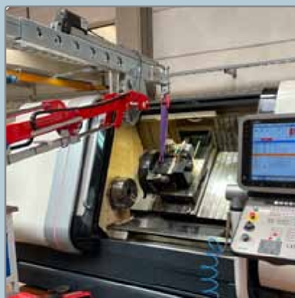
Elektricky teleskopický adaptér instaluje CNC frézovací systémy.
