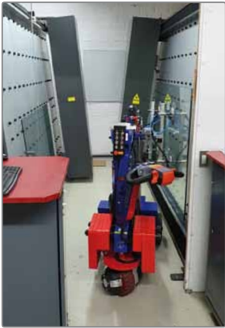
Funkce výkyvu do strany ve stísněných prostorech
