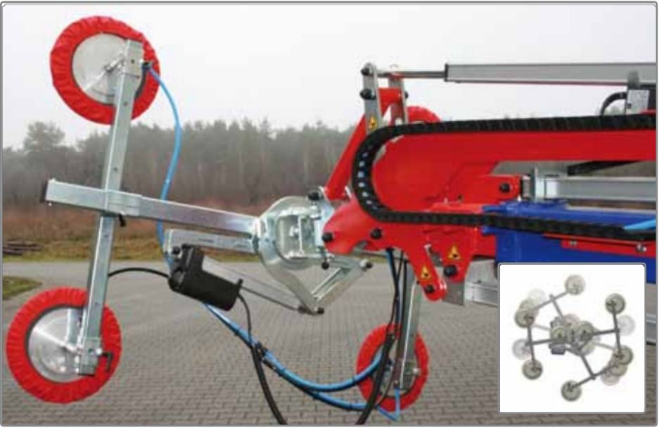
Zařízení se speciálním otočným kloubem* usnadňuje instalaci: všechny pohyby otáčení a naklápění jsou řízeny elektricky.
