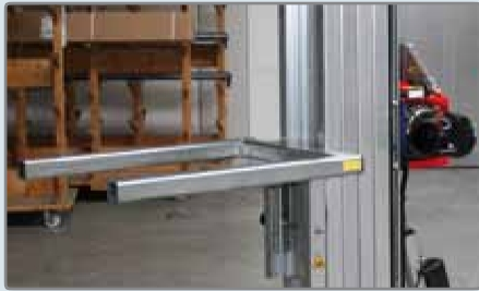
Výšku nastavujete elektrickým navijákem.
