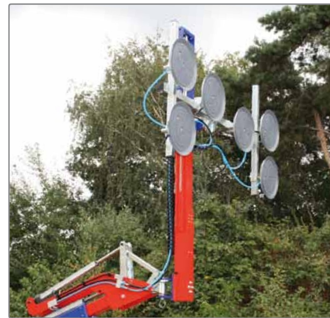
Teleskopické rozšíření* pro všechny roboty KS.
