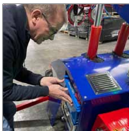
Zásuvka na baterie pro snadnou výměnu baterií.
