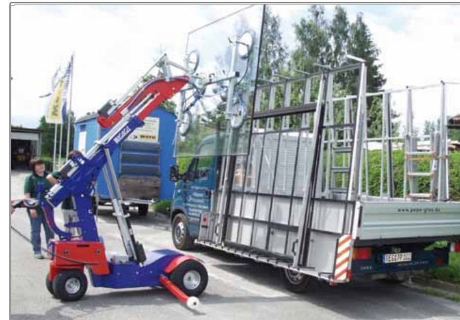
KS Robot 600 Offroad při nakládání skleněných tabulí.
