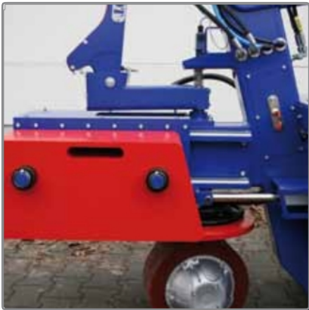
Pohyblivá protizávaží pro lepší rozložení váhy.
