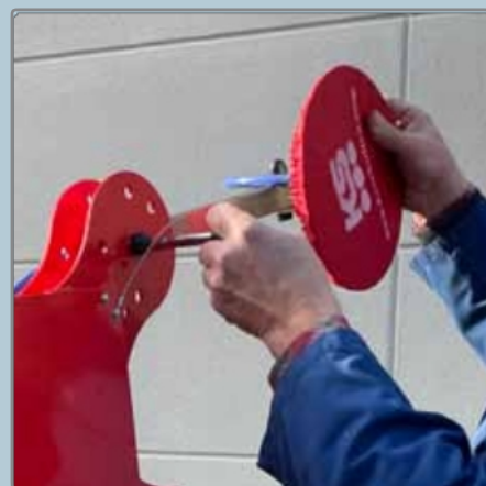
Flexibilní přísavné talíře pro různé formáty skla
