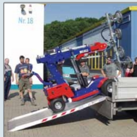
Komfortní: KS Robot lze na staveništi přepravovat pomocí nakládací rampy*.
