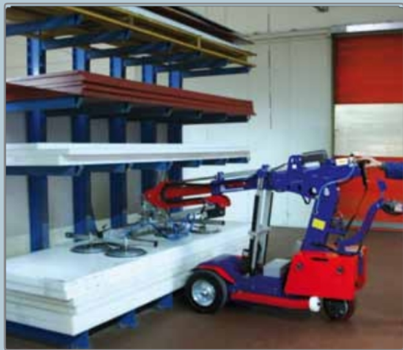
Zvedání těžkých desek přímo z police.
