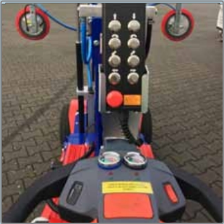
Dálkové ovládání s kabelem a multifunkční volant usnadňují provoz
