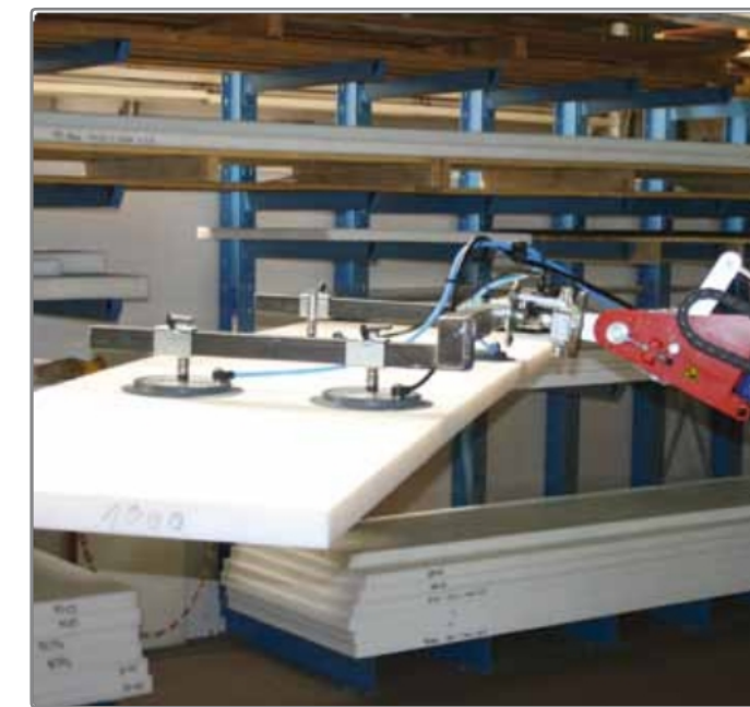
Speciální vidlice* vyndává pláty z police s nízkou výškou.
