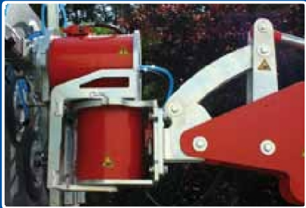
HDS-Modul: Hydraulický otočný kloub (do strany +/- 270°) a kolem osy (+/- 90°)
