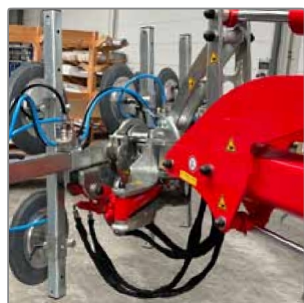
KS Robot 1025 Offroad s hydraulickým otočným válcem, volitelné.
