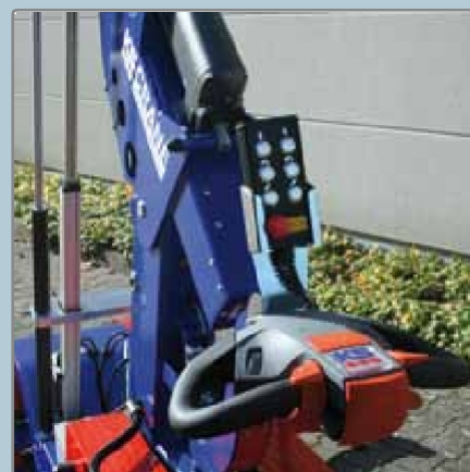
Multifunkční volant a kabelové dálkové ovládání.
