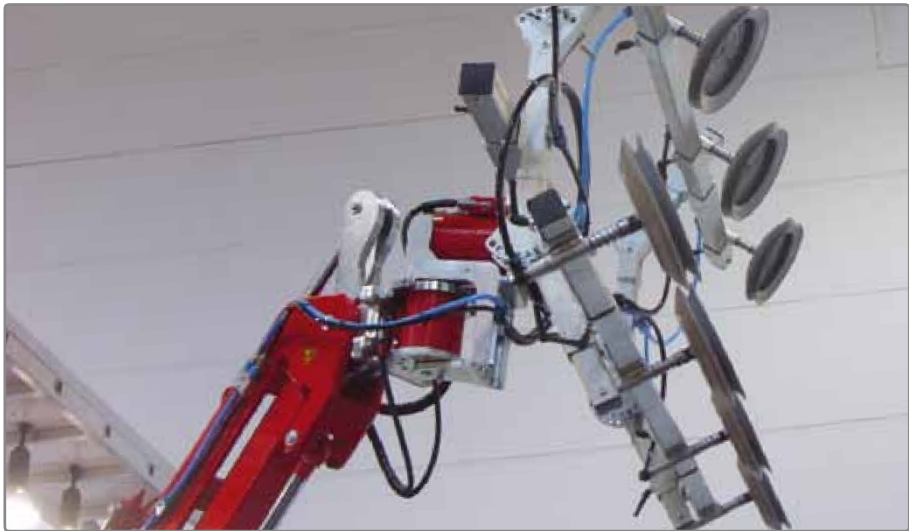
Hydraulické otáčení* (do stran +/- 270°) a otáčení kolem osy (+/- 90°)
