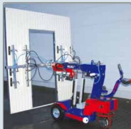
Ideální: náklad je přisátý tenkými přísavnými talíři* pro trapézové desky.
