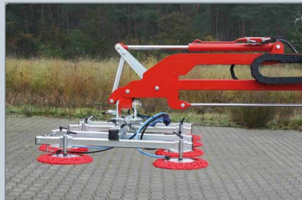
▲ Speciální kloub pro elektrické naklápění vakuového sacího systému z palety do horní polohy. Umožňuje také nabírat vodorovné prvky, např. na pracovních stolech nebo výrobních linkách.
