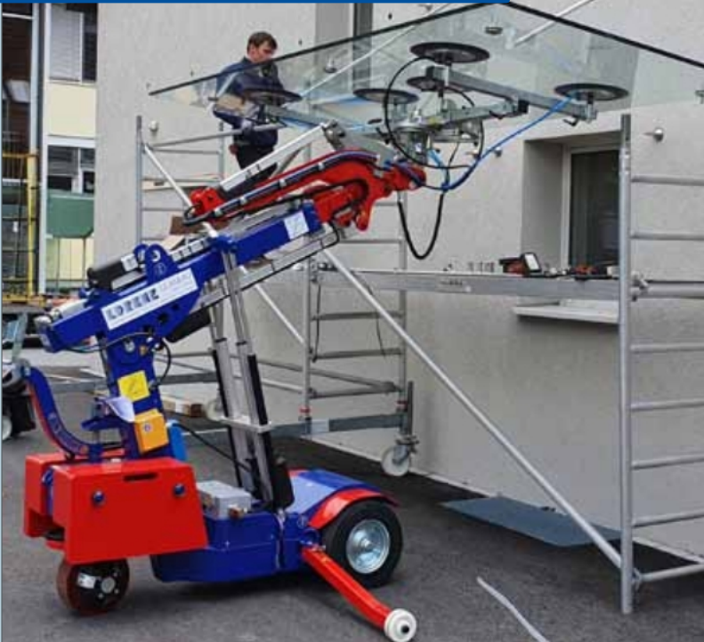
Teleskopický výsuv, zvedání a spouštění se provádí elektricky pomocí vysoce kvalitního synchronizovaného ovládání.
