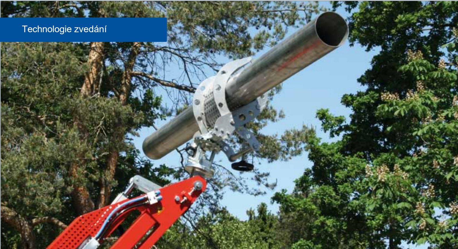
Speciální chapadlo na koberce nebo kovové trubky - je možné elektricky i mechanicky.
