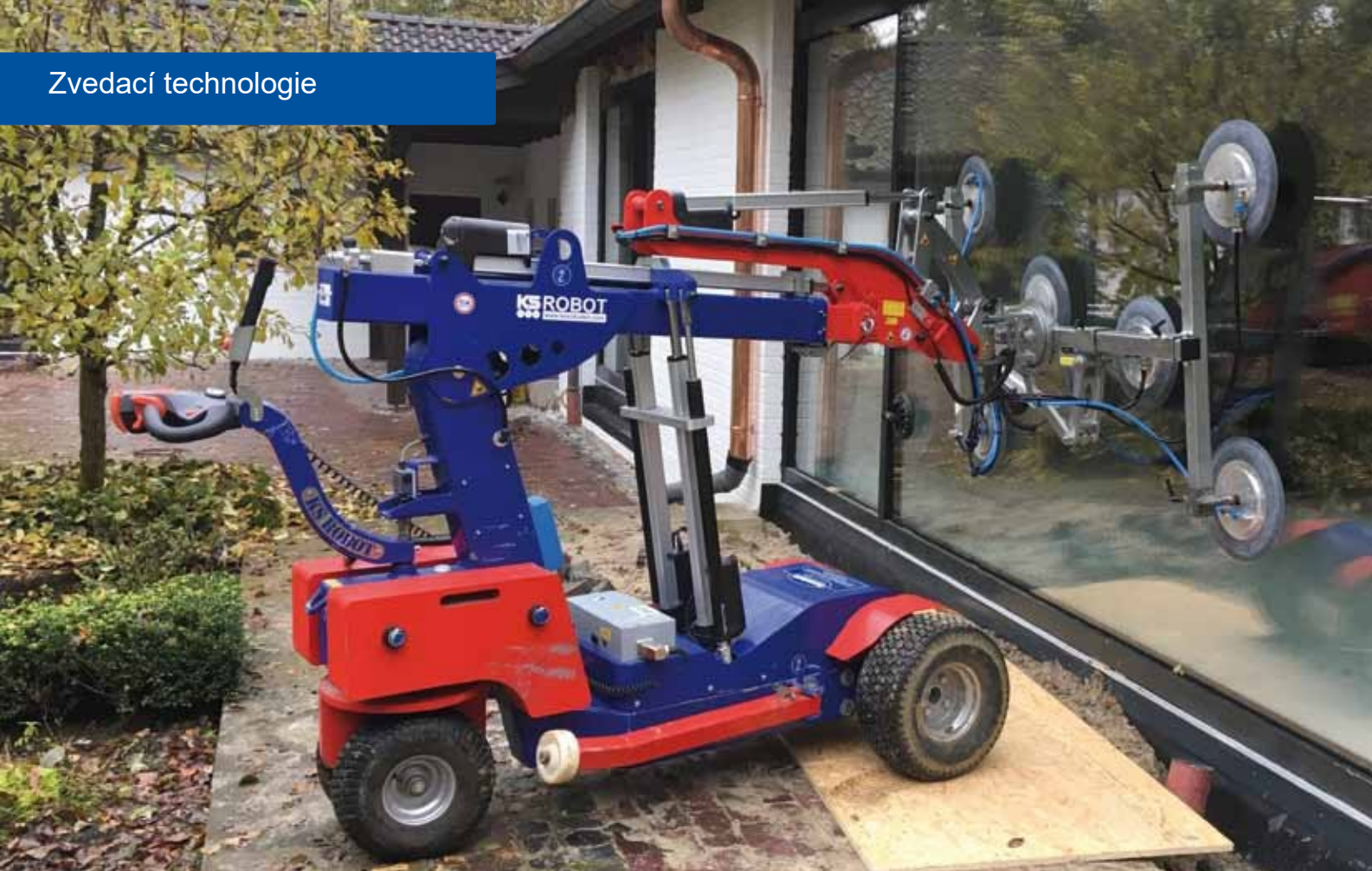
Všechna zařízení KS Offroad jsou vybavena kvalitním synchronním řízením a elektrickým pohonem, který zajišťuje plynulý a hladký pohyb.
