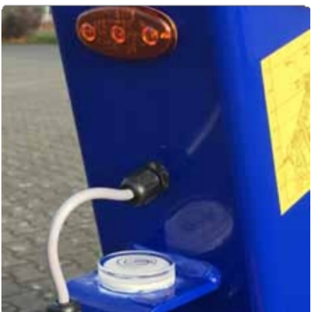
Vizuální bezpečnostní prvky: k dispozici je monitor baterie a vodováha
