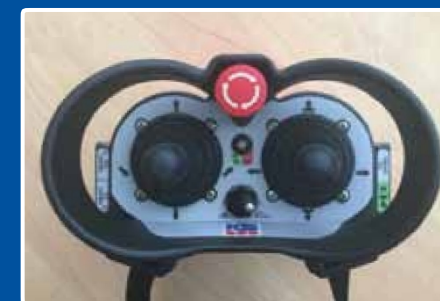
Včetně dálkového ovládání serva pro KS Robot 800 / 1000
