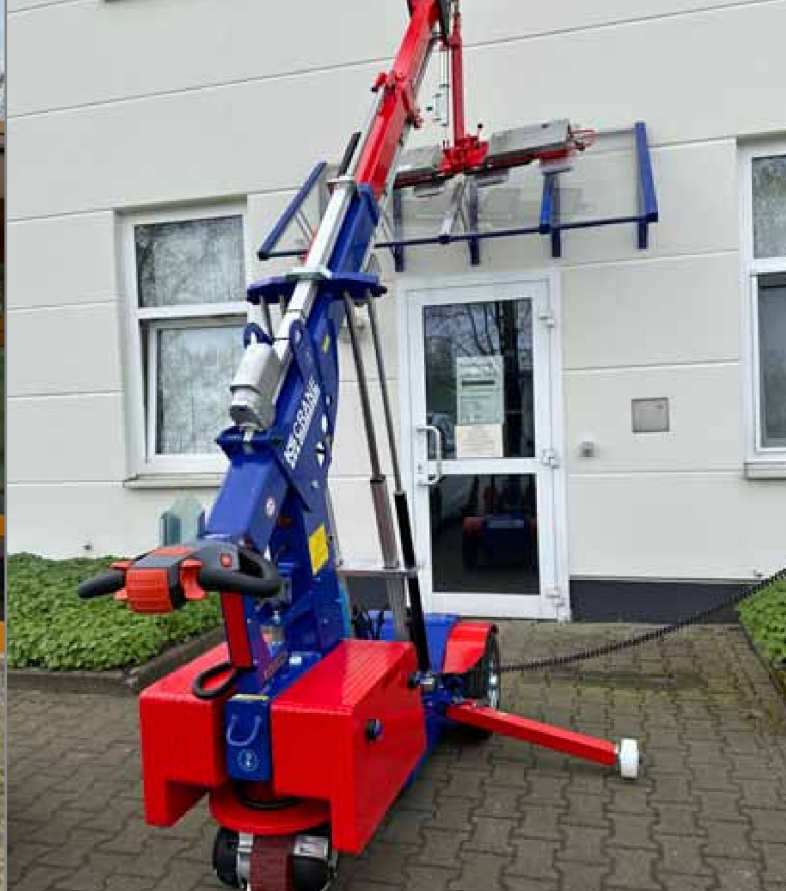
▲ Nakládací a montážní jeřáb s elektrickým pohonem a elektrickým dvojitým teleskopem.
